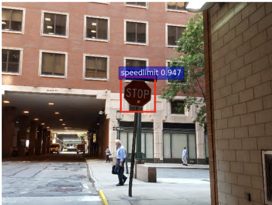
Obr. 3.1: Obrázok je z práce [20], kde otrávil systém detegujúci dopravné značky tak, že systém klasifikoval bežné značky správne, ale ak na nich bola špeciálna nálepka, klasifikoval ich zámerne nesprávne. Tu môžeme vidieť, že stop značka s malou žltou nálepkou bola klasifikovaná ako rýchlostný limit
