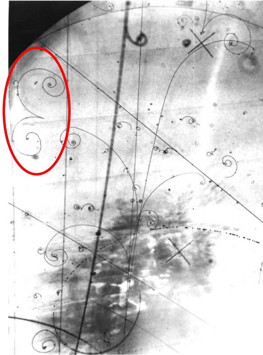
Snímka z bublinovej komory, vytvorenie páru elektrón pozitron
