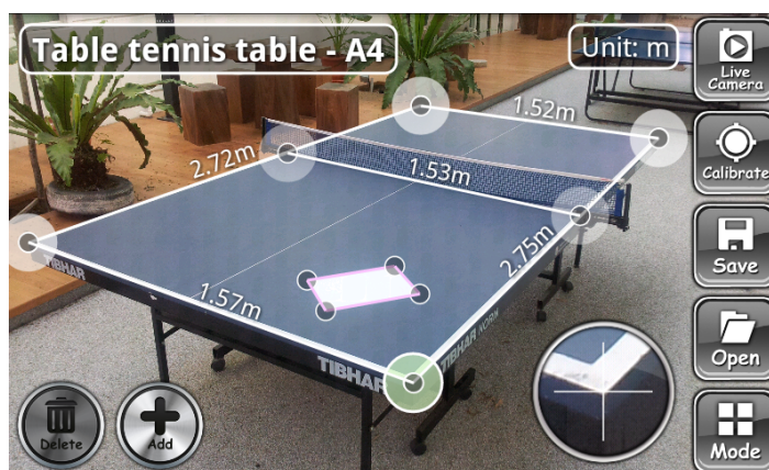
Obr. 1.8: Ukážka merania dĺžky hrán stola na stolný tenis v aplikácii On 3D-CameraMeasure.[4]
