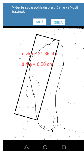
Obr. 5.4: Nesprávne nájdanie chodidla spôsobené slabým obrysom.
