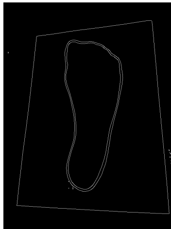
Obr. 3.7: Cannyho transformácia použitá na náš obrázok chodidla.
