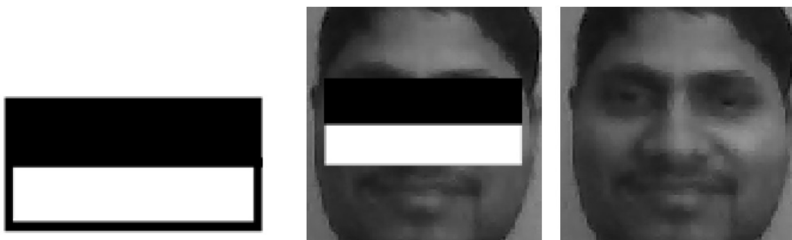
Obr. 1.1: Ukážka Haarovového príznaku. Na obrázku môžeme vidieť podobnosť príznaku s ľudskou tvárou. V oblasti očí je tvár tmavšia, ako v oblasti líc. [17]
