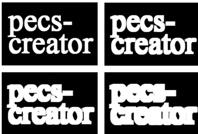
Obr. 5.2: Ilustrácia aplikovania operácie "Dilation" na rozšírenie objektov. Zľava doprava, od pôvodného obrázku po 3 iterácie operácie.
