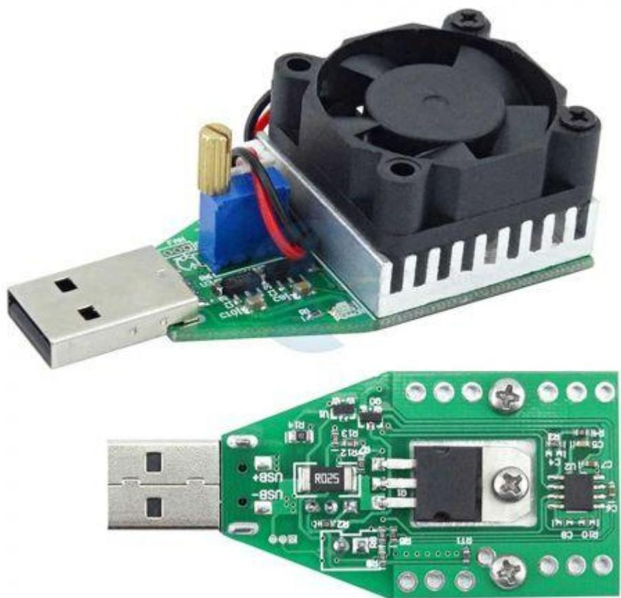
Elektronická zátaž pre jednosmerné napätie. Max zaťažiteľnosť 15W pri max 13,7V, 3A
