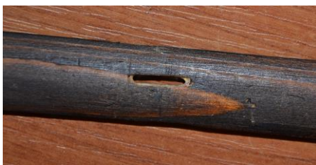
Obrázok 14: Otvor v tyči kyvadla pre kolík ramena
