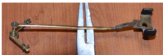
Obrázok 10: Pôvodná (pokazená) vidlica s teplom sa zvrášťujúcou fóliou na nastavenie jej šírky.
