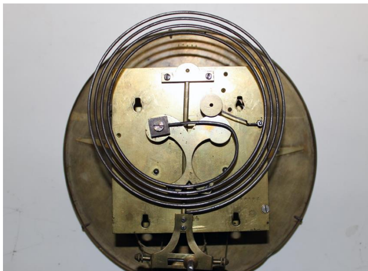
Obrázok 7. Príklad strojčeka výroby Remember (typické kladivko, ložisko kotvy a rameno kotvy). Staršie modely (ako aj tento) mali stĺpiky pevne vsadené do jednej z platní, neskoršie boli upevnené skrutkou.
