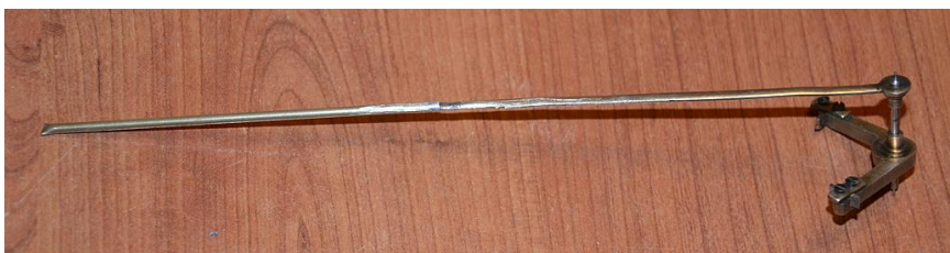
Obrázok 11: Rameno nadstavené mosadznou rúrkou
